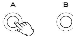
Betätigen Sie zum Einstellen von „A2“ oder „B2“ die entsprechende Frequenzwahltaste (A oder B) länger als zwei Sekunden.
