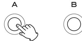
Sofern für „A2“ ein anderer Wert als für „A1“ eingestellt ist, betätigen Sie die „A“-Taste, sobald „A1>“ im Display erscheint, um lediglich die Ausgangsfrequenz von „A1“ zu ändern. Gehen Sie entsprechend vor, um die Einstellungen von Ausgang „B“ zu ändern.
