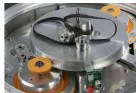
Clockwork Orange? – Das Innenleben erinnert mit präzisen Frästeilen an ein mechanisches Uhrwerk. Mit wenigen Handgriffen sind die orangen Reibräder gegen zwei Pulleys ausgetauscht, und der Muse 3C wird zum Riemetriebler.
